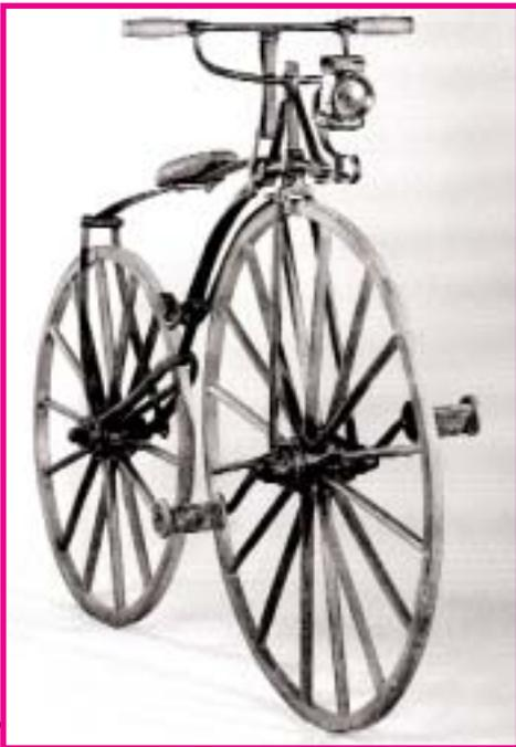
A sinistra la Michaudina francese costruita nelle officine Michaux nel 1867. Ha il telaio in ferro massiccio. Sulla ruota anteriore ci sono le prime pedivelle con pedali. Sulla ruota posteriore il primo freno costituito da una paletta di ferro, azionata da una cordicella che si tira ruotando le manopole del manubrio.
