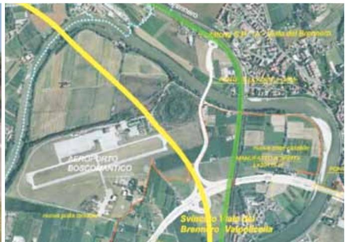
**FIG2** Sovrapposizione del tracciato della tav (o tac) con quello del passante.
