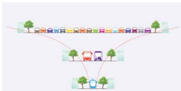
FIG3 Per trasportare 50.000 persone all'ora in una direzione occorre: - una sezione stradale di 175m se usata esclusivamente da automobili - una sezione stradale di 35m se riservata esclusivamente ai bus - una sezione stradale di 9m se usata solo da sistemi tranviari
